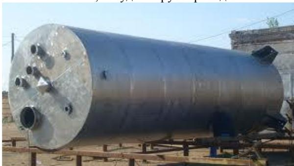
**Рис. 2.1.4 - Емкости из нержавеющей стали**
