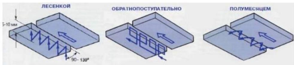
**Рис. 11.2 – Способы выполнения потолочных швов**
