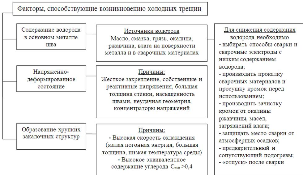
**С целью уменьшения склонности металла к образованию холодных трещин применяются следующие меры:**
