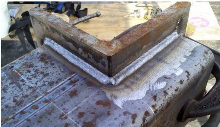
Рис. 6.5- Пример внешнего вида шва после сварки под слоем флюса
