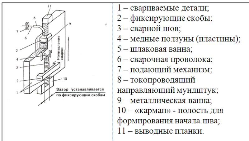
Рис. 6.6. схема ЭШС
