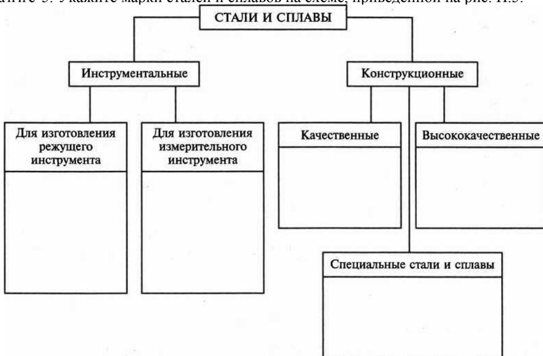
Рис. П.5. Классификация сталей и сплавов
